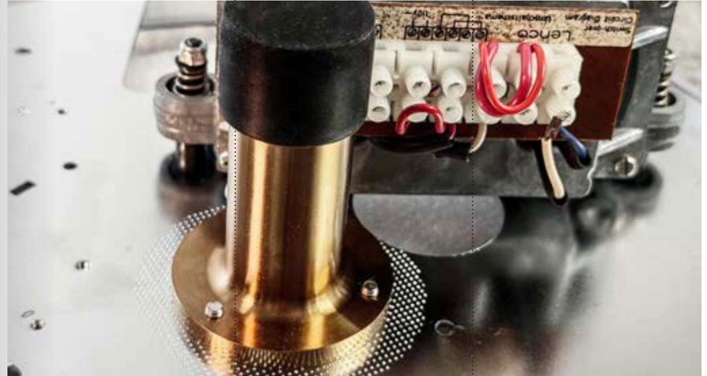
Die Motorbefestigungsbolzen sind kunststoffummantelt und die Motorfedern lagern auf Kunststoffscheiben. Dadurch ist das Motorgehäuse vom Chassis elektrisch entkoppelt und kann so separat über den Schutzleiter des Netzanschlusses geerdet werden. Gut zu erkennen auch das massive Tellerlager von Audio-Creative.
